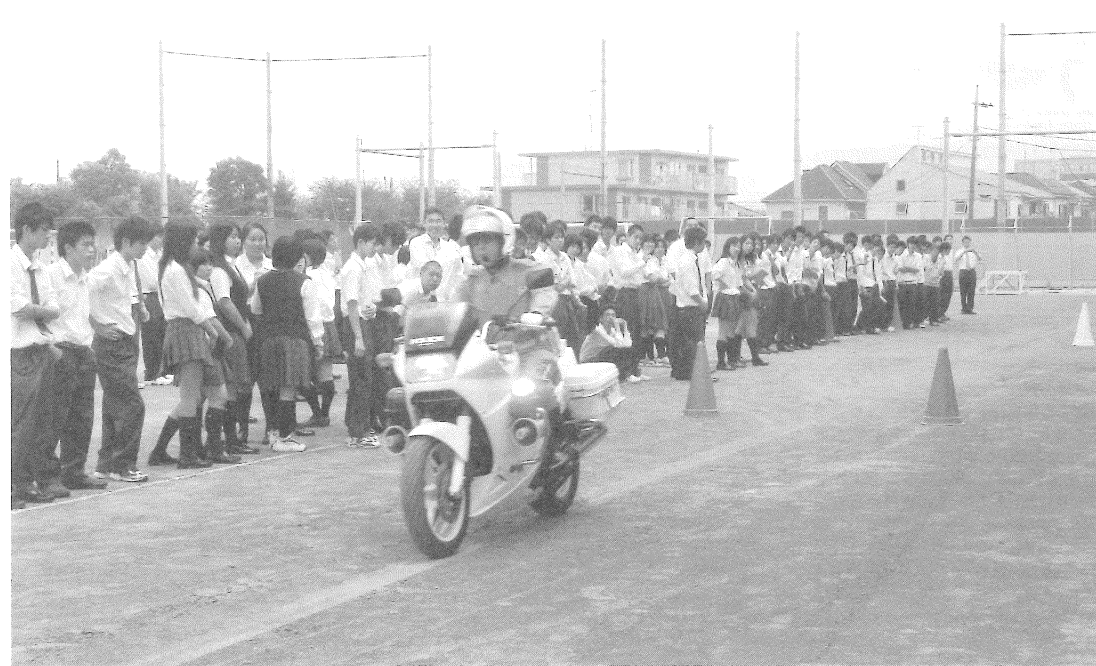
圧差だらた、校庭での白バイ隊員による急制動実験。フロントブレーキ、リアブレーキ、エンジンブレーキの3つをバランスよく使えば、こんなに安定して短い距離で止まれるのわー！
