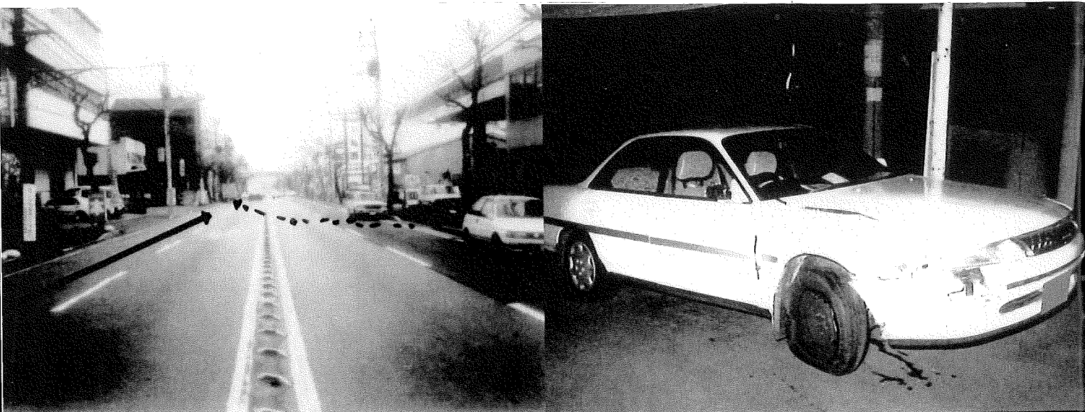
▲加害車両の破損は右前部。追突箇所である右前輪のリムが変形している
